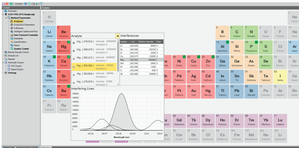
รูปที่ 1 แสดงตัวอย่างการเลือกความยาวคลื่นจากโปรแกรม Qtegra
