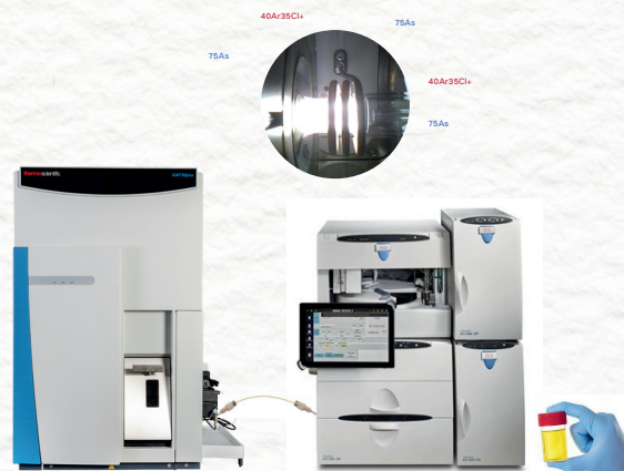
ภาพที่ 1 แสดงการเชื่อมต่อเครื่อง ICS6000 กับ iCAP RQ plus
