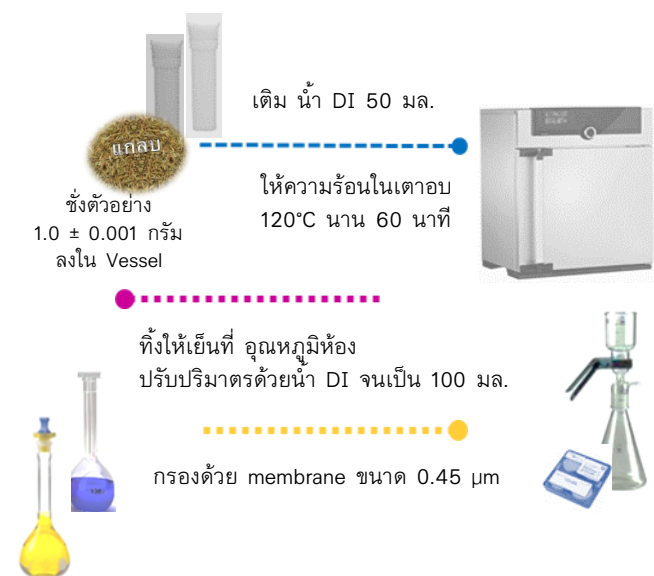
รูปที่ 1 การเตรียมตัวอย่างตามวิธีมาตรฐาน ISO 16995
