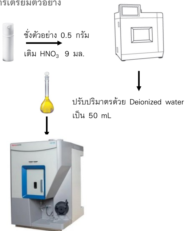
รูปที่ 1 เครื่อง iCAP Pro X (ICP-OES) Thermo Scientific
