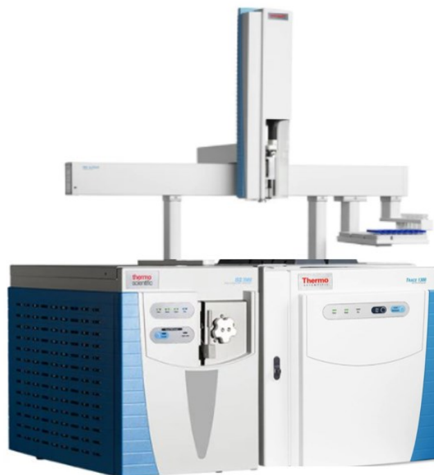
รูปที่ 1 Thermo Scientific ISQ7000 GC-MS
