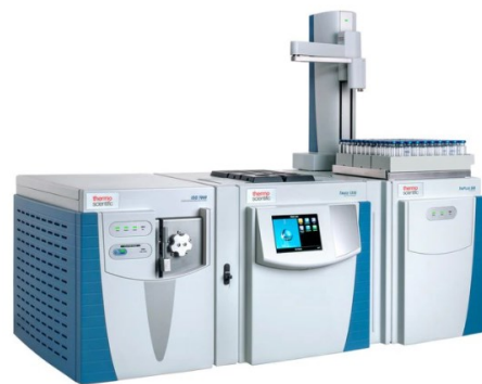
รูปที่ 2 แสดงเครื่องแก๊สโครมาโตกราฟี-แมสสเปคโตรมิเตอร์ และวาล์วสำหรับฉีดตัวอย่าง
