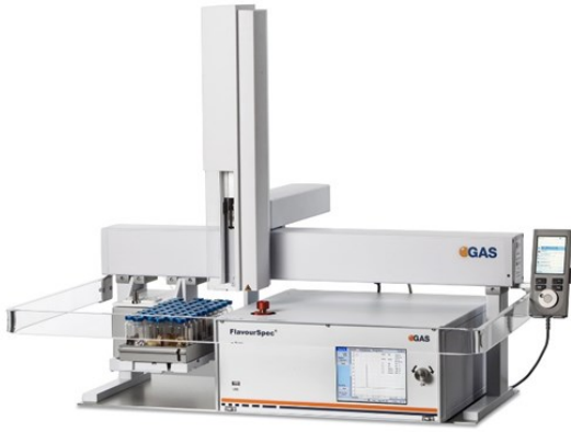
รูปที่ 3 แสดงเครื่อง HS-GC-IMS
